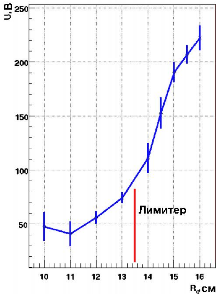
Рис. 3.35. Зависимость потенциала в плазме от радиуса при магнитном поле в центре
