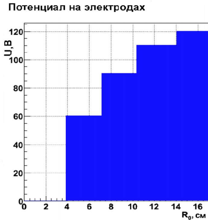
Рис. 3.12. Распределение потенциала по радиальным электродам в выстреле. На лимитере \approx 130 В, остальные электроды под плавающим потенциалом
